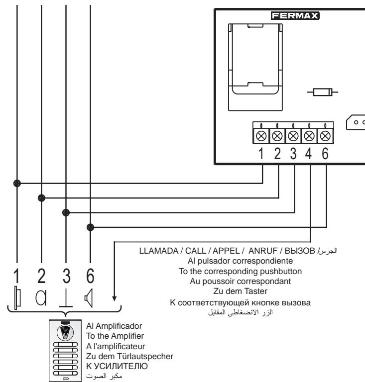
**es.** Los teléfonos Citymax permiten una instalación rápida y sencilla. Tan sólo conecte los terminales indicados haciéndolos coincidir con los correspondientes símbolos en el amplificador.
