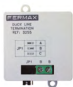
3255 ZAKOŃCZENIE LINII DUOX PLUS Instalacje mieszane lub video: 2 na pion. Instalacje audio: 1 na pion.
