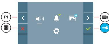
Der Monitor VEO XS enthält ein OSD-Menü, das über die Monitortasten bedient werden kann. Die auf dem Bildschirm angezeigten Symbole werden mit den entsprechenden Monitortasten bedient.
