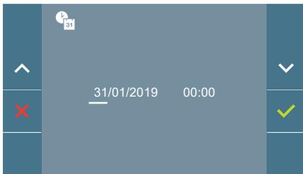
O monitor permite ajustar a data e a hora. Através dos ícones de navegação podemos alterar os ajustes de data e hora e navegar pelos mesmos. Premir o ícone ✓ para confirmar a seleção.
