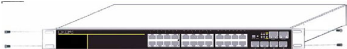
Fig 2-1 Mocowanie uszek do przełącznika
