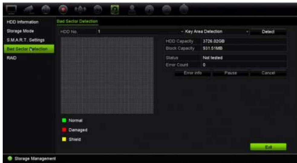
Rysunek 33: okno wykrywania uszkodzonych sektorów
