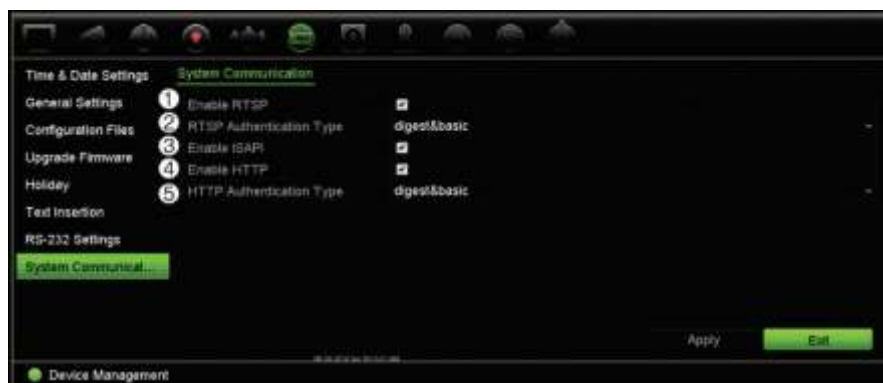
Rysunek 31: Okno Ustawienia komunikacji systemowej
