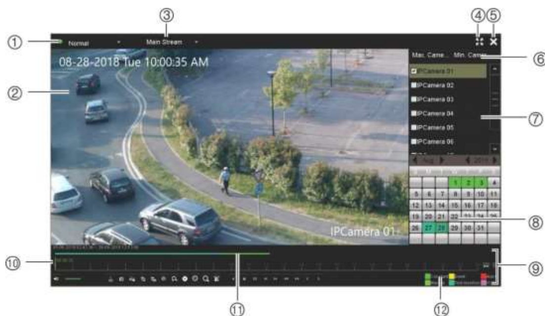
Rysunek 15: okno odtwarzania (pokazane odtwarzanie 24-godzinne)
