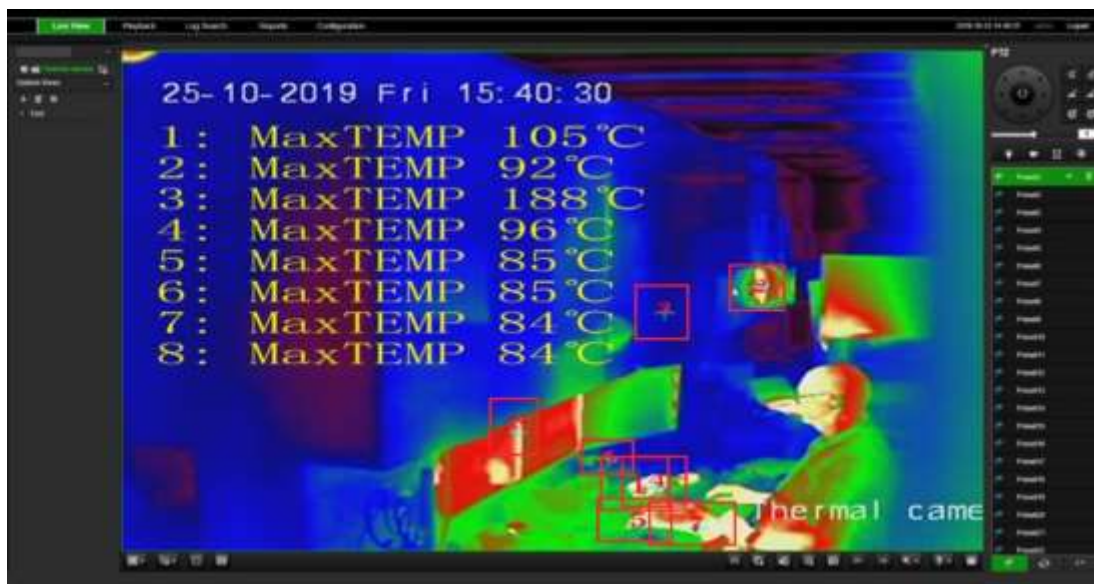
Rysunek 35: Przykładowy widok wyników działania funkcji Punkt zapłonu w oknie podglądu na żywo
