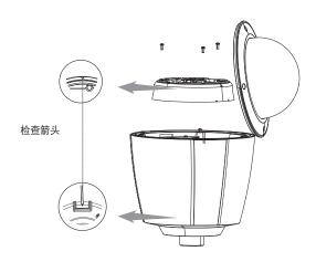
2. 请将外部线缆穿过"管道或底座"内部并拉出。请用特氟龙胶带缠住"机盒"的螺钉部分。
