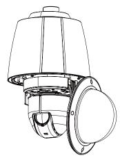
8. 설치가 제대로 되었는지 확인한 후, 하우징 커버를 덮고 4개의 나사를 이용해 단단하게 조이세요.
