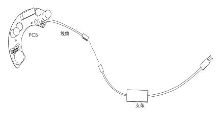
6. 将外部摄像机线缆插入机盒后,连接到支架上对应的插孔。 (有关线缆连接的详情,请参阅摄像机安装手册。)
