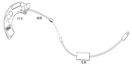
5. 参阅安装手册连接摄像机支架和内部线缆后,将摄像机安装到机盒上,检查支架挂钩是否正确固定到摄像机上。
