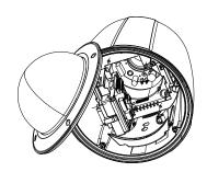
7. 请将摄像机安装在机盒上。 请确认支架挂钩正确固定到摄像机上。
