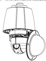
8. 确认装置已正确安装后,安装机盒盖并用 4 个螺钉固定住它。
