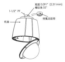
4. 请参阅下图,按顺时针方向转动机盒,安装到管道上。
