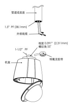
3. 请参阅下图,按顺时针方向转动机盒,安装到管道上。
