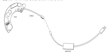
5. 설치 설명서를 참조하여 카메라 어댑터와 내부 케이블을 각각 연결한 후, 하우징에 카메라를 설치하고 어댑터의 후크를 카메라에 제대로 고정했는지 확인하세요.
