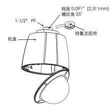
4. 请参阅下图,按顺时针方向转动机盒,安装到管道上。
