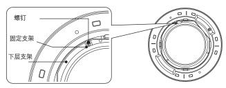
8. 确认已正确完成安装后,卸下摄像机的圆顶盖。 安装机盒盖并用 4 个螺钉固定住它。
