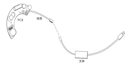
6. 将外部摄像机线缆插入机盒后,连接到支架上对应的插孔。 (有关线缆连接的详情,请参阅摄像机安装手册。)
