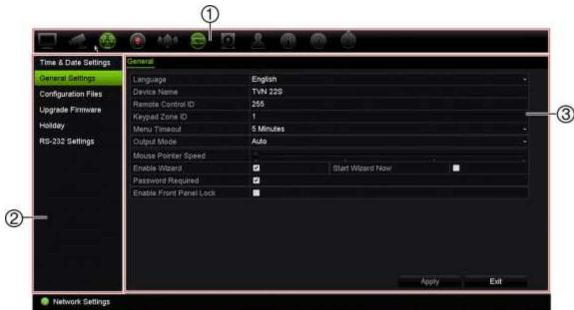
Rysunek 7: struktura menu
