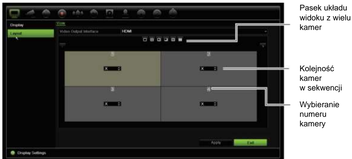
Rysunek 21: okno Układ kamer
