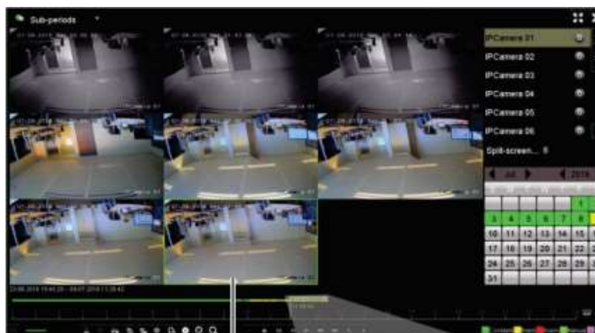
Rysunek 18: przykład odtwarzania na ośmiu podzielonych ekranach
