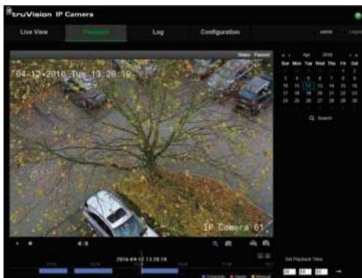
Rysunek 27: Nagrywanie obrazu na karcie SD w trybie odtwarzania
