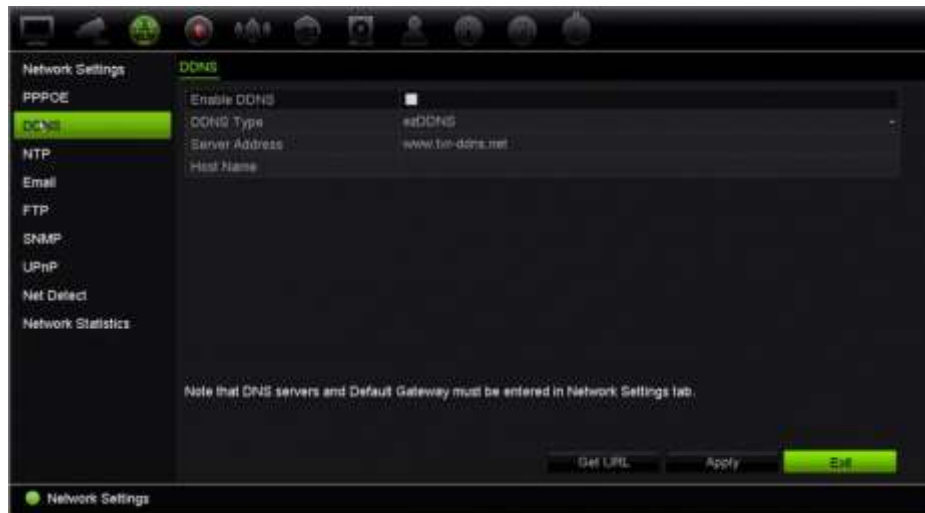
Rysunek 25: okno konfiguracji usługi ezDDNS
