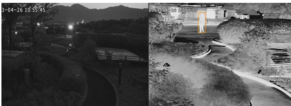
[Rysunek 15. Różnica widoczności pomiędzy kamerą widzialną (po lewej) a kamerą termowizyjną (po prawej) w nocy środowisko]
