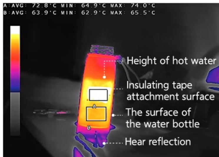
[Rysunek 21. Różnica w obrazie termicznym w zależności od emisyjności podczas napełniania butelki z gorącą wodą]
