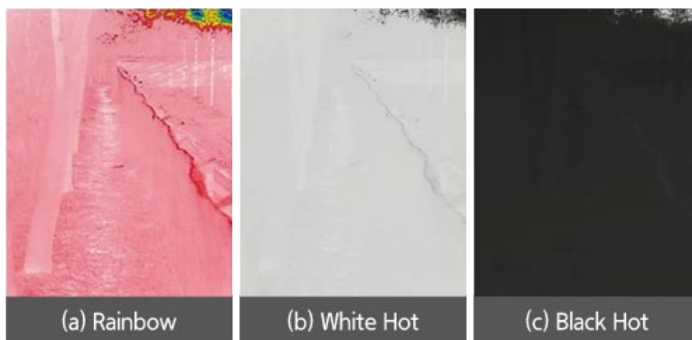
[Rysunek 19. Obrazy, które powstają, gdy różnica temperatur między obiektem a jego otoczeniem otoczenie nie jest istotne]
